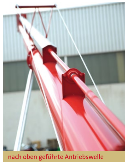
nach oben geführte Antriebswelle
