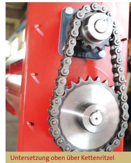
Untersetzung oben über Kettenritzel
