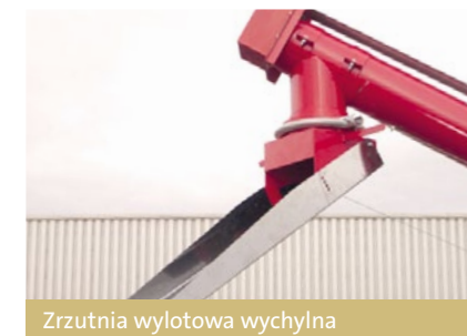
Zrzutnia wylotowa wychylna
