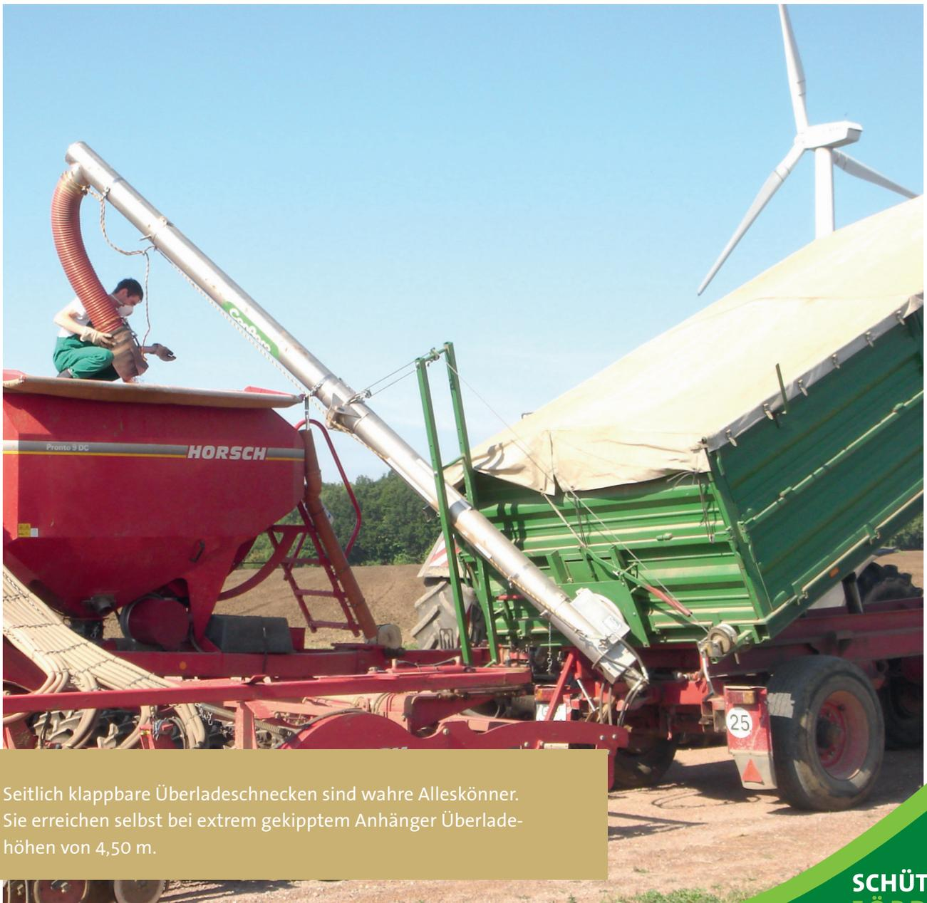
Seitlich klappbare Überladeschnecken sind wahre Alleskönner. Sie erreichen selbst bei extrem gekipptem Anhänger Überladehöhen von 4,50 m.
