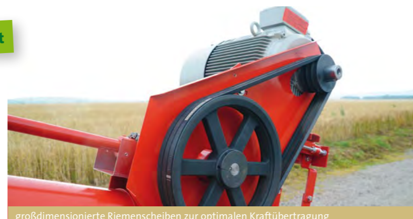
großdimensionierte Riemenscheiben zur optimalen Kraftübertragung
