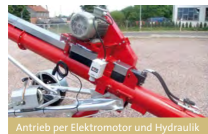
Antrieb per Elektromotor und Hydraulik
